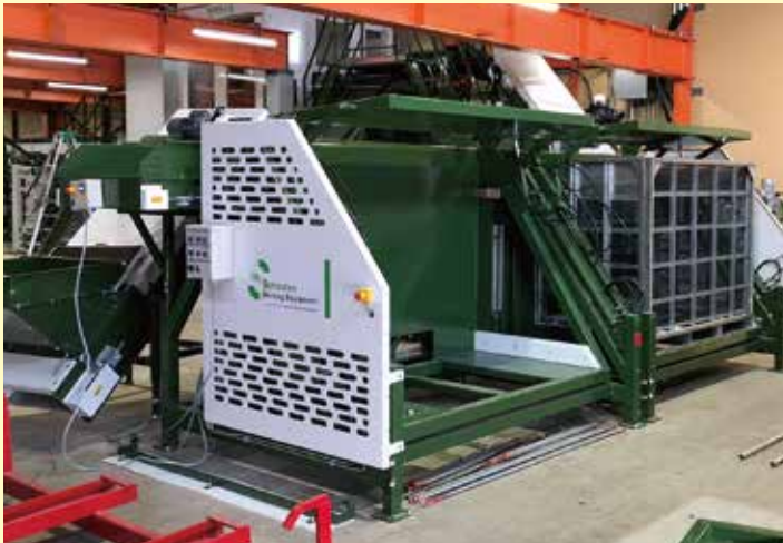
コンテナダンパー (原料投入)
